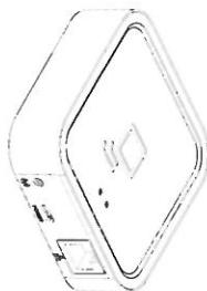
**Termoweb Center:** el centro de su Sistema Termoweb, enlaza inalámbricamente sus dispositivos y se conecta a Internet a través de su router. Le permite controlar sus dispositivos desde cualquier lugar del mundo mediante el portal web o nuestras aplicaciones móviles. (Termo Smart/ Termo Smart electric)
