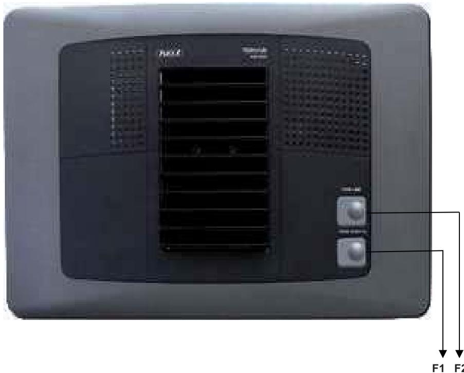
**F1.-FUSIBLE TIPO F** (fusión rápida) 1A-250VAC protección en la entrada de red de 230VAC
