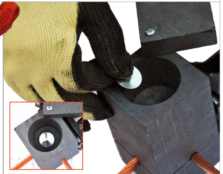
Introducir disco metálico en el fondo obturando el canal de soldadura.
