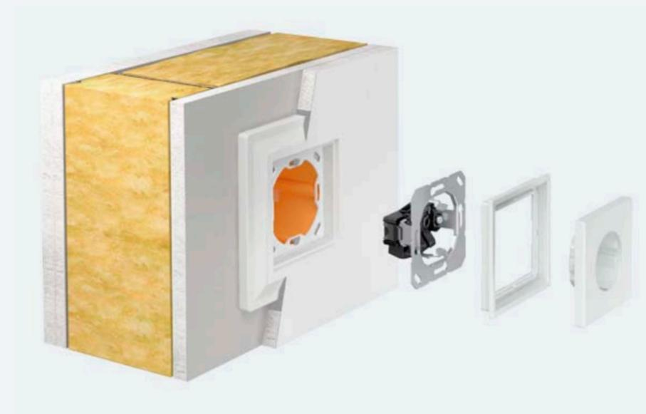
El requisito para el montaje en construcción en seco es el revestimiento doble de la pared de construcción en seco. El adaptador para montaje enrasado presenta la misma altura de perfil que una plancha de yeso (12,5 mm) y permite así la unión positiva y material con la superficie.
